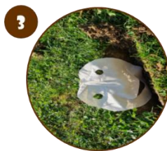
3 Smiley einlegen und Loch schließen (1-2 cm des Stoffs können an der Oberfläche bleiben)
